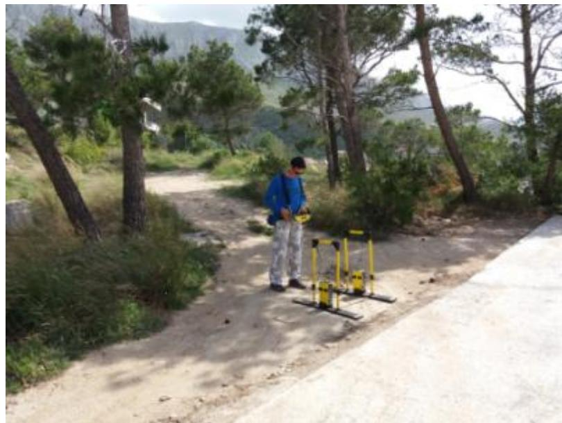
Slika br. 7 - Georadarski instrument **pulseEKKO PRO** na jednoj od pozicija snimanja
